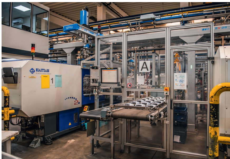
Gefertigt wird das 2-Komponenten-Bauteil „Haube mit Fenstern“ vollautomatisch auf zwei Spritzgießmaschinen Haitian Mars II mit 2000 kN Schließkraft. Sie stehen im Abstand von 4 m parallel nebeneinander und arbeiten um 20 s zeitversetzt. © GS Kunststofftechnik
